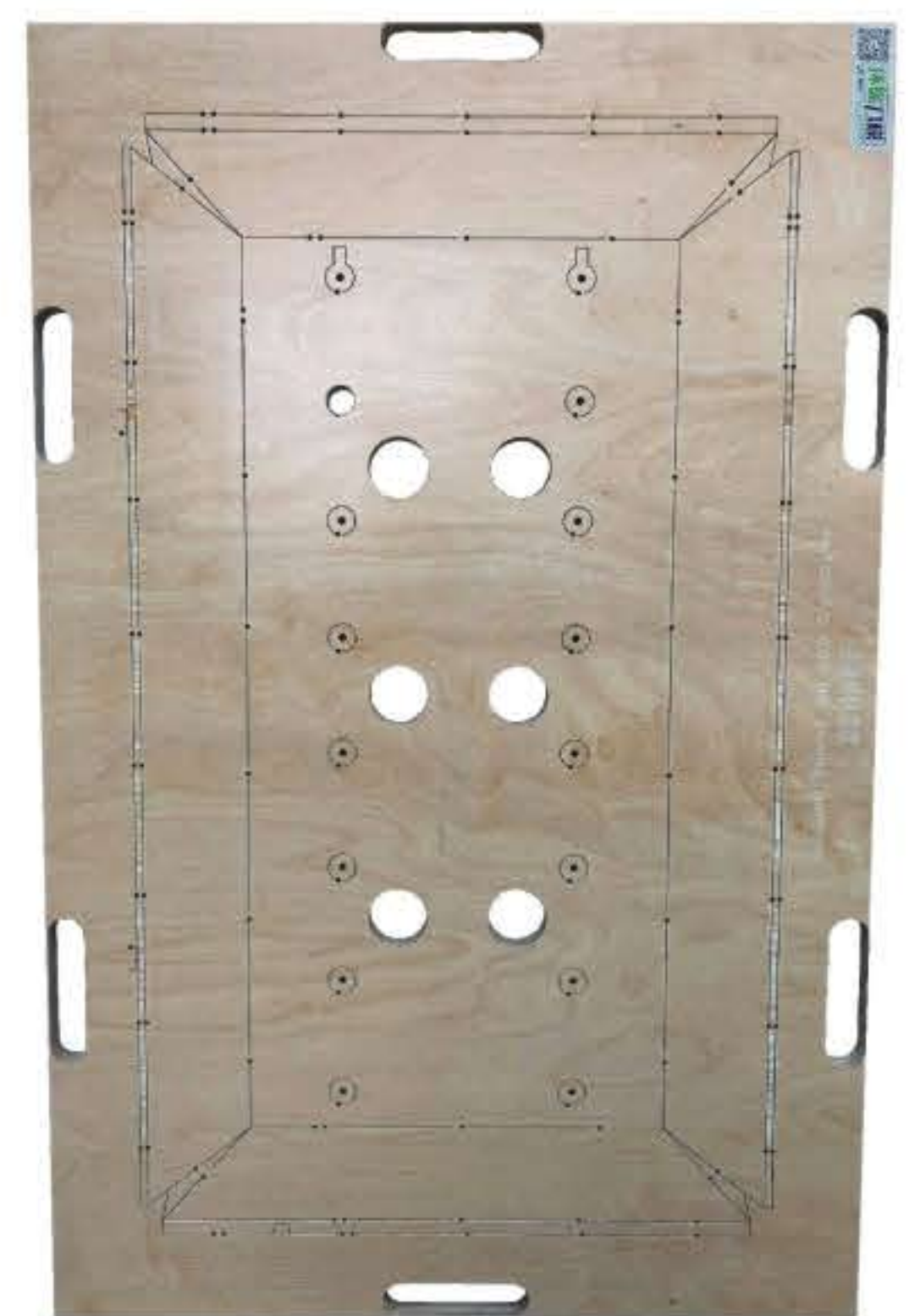
加工大尺寸光电类“芬兰板”刀模
